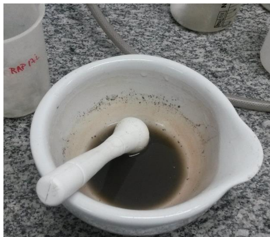
Figura A3.2: Mistura no almofariz para desagregação do material argiloso.
