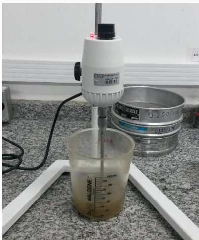
Figura A3.1: Conteúdo da amostra, pirofostato de sódio e água destilada em misturador mecânico.
