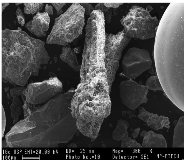
Figura 8.2a: Agregado antrópico (fragmento de borracha de pneu) em micrografia de elétrons secundários (amostra MP-PTE C.U.).
