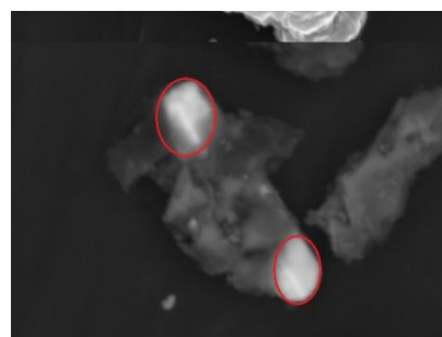
Figura 7.5b: Zircão (em destaque) em micrografia de elétrons retroespalhados (amostra MP-PTE C.U.).
