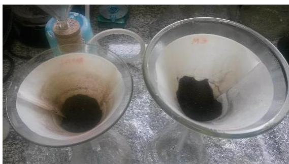
Figura A3.5: Filtragem, realizada após a elutriação, no conjunto de funis, kitsatos e papéis de filtro.
