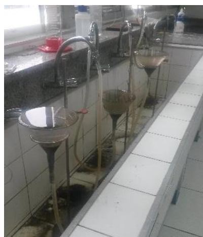
Figura A3.4: Execução da elutriação, com a utilização de funis, mangueiras flexíveis e hastes.
